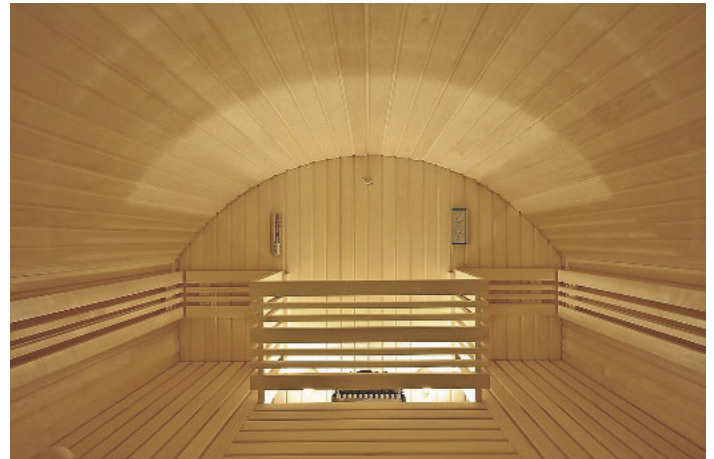
/ Exakt eingepasst: Diese Sauna in einem Gewölbekeller wurde in der Werkstatt von Klumpf Wohndesign vorgefertigt und bauseits in die Kontur des Raumes eingefügt.
